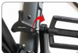
Montage der Pedale: Beide Pedale werden jeweils zum Vorderrad hin eingedreht.
