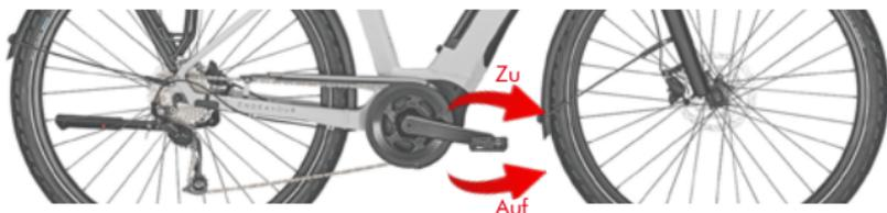
Drehen Sie nun von Hand die Pedale in die Kurbel, um ein Verkanten zu verhindern. Ziehen Sie dann die Pedale kräftig (!) mit ca. 35 Nm fest.
